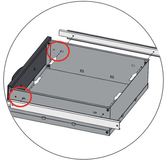
Schrauben Sie die Schublade mithilfe des Schraubensets M5x6 (24) wie dargestellt an die bereits installierten Schubladenschienen. Wiederholen Sie diesen Schritt für jede Schublade.
