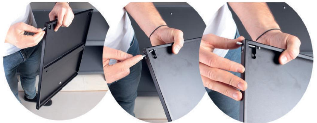
Führen Sie den Federsplint mit dem gewinkelten Ende zuerst in das große der drei Löcher. Danach schieben Sie das gewinkelte Ende wie dargestellt in das äußere Loch und zwar soweit, bis der ganze Stift durch das erste große geschoben ist. Danach führen sie das gerade Ende rückwärts durch das obere äußere Loch. Wiederholen Sie diesen Schritt auf der gegenüberliegenden Seite der Tür.
