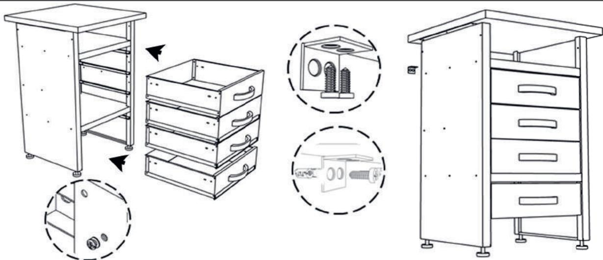
Führen Sie die Schubladen an den vorgesehenen Stellen ein. Schrauben Sie die beiden Anbauwinkel (AW) an der Arbeitsplatte (AP) fest. Vor der Verwendung der Werkbank fixieren Sie mit Hilfe der Anbauwinkel (AW) und den Schneidschrauben diese an der Wand. Für die Befestigung an der Wand empfehlen wir die Verwendung von Schrauben mit den Maßen M5x40 und Dübeln mit den Maßen von M8x40, um eine bestmögliche Stabilität zu gewährleisten.
