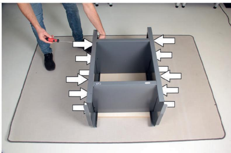
Verschrauben Sie die Fachböden (4) mit den Seitenwänden (1,2) an den gekennzeichneten Stellen.
