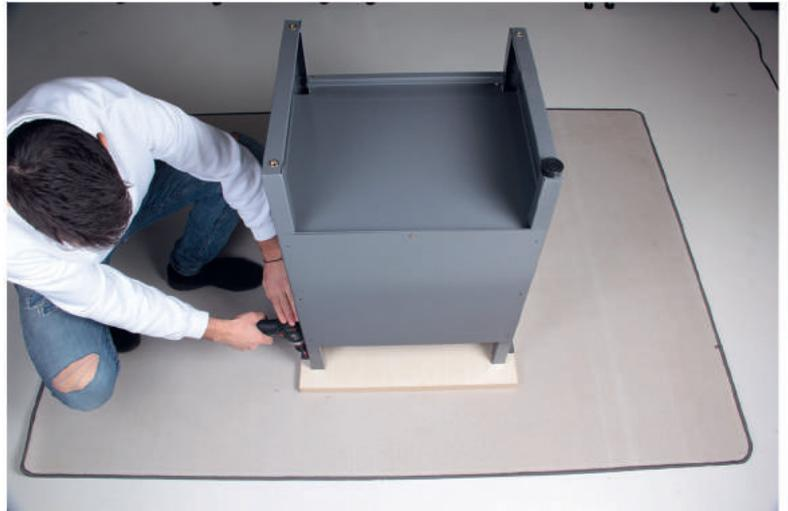
Richten Sie den Unterbau an den von Ihnen markierten Punkten (Schritt 2) aus. Schrauben Sie die Arbeitsplatte an den 6 dafür vorgesehenen Löchern an. Benutzen Sie dafür die Schneidschrauben (25). Kippen Sie anschließend mit einer zweiten Person die Werkbank nach vorn, sodass Sie in der Endposition auf den Justierfüßen steht. Positionieren Sie die Werkbank an ihrem vorgesehenem Platz im Raum. Achten Sie dabei darauf, die Werkbank nicht über den Boden zu ziehen.
