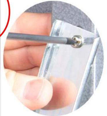
Schrauben Sie alle Schubladenschienen (S4) wie dargestellt mit je 2 Schraubensets M5x8 (23) an die Seitenwand 1 und die Seitenwand 2 an. **ACHTUNG:** Die Schraubenköpfe müssen in Richtung der Schubladenschienen zeigen.
