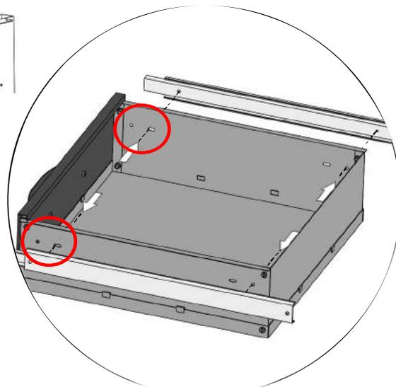
**Tip:** Ziehen Sie die Schubladenschienen vorher aus und schrauben Sie zuerst die beiden vorderen Schrauben an (rote Markierung).
