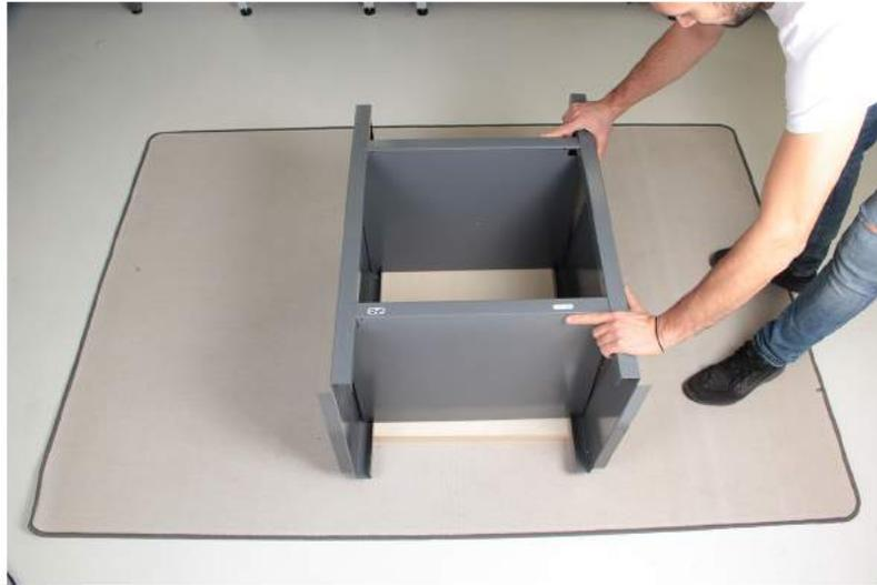
Führen Sie die seitlichen Nasen der Fachböden (4) in die rechteckigen Aussparungen der Seitenwände (1,2).
