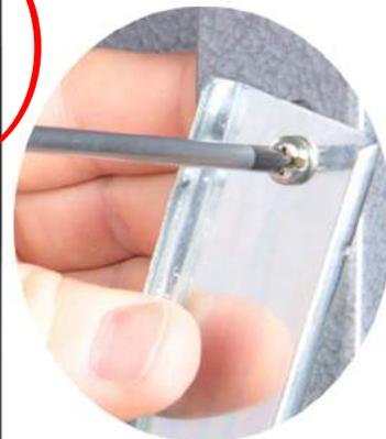
Schrauben Sie die Schubladenschielen (S4) wie dargestellt mit je 2 Schraubensets M5x8 (23) an die Seitenwand 1 und die Seitenwand 2 an. Wiederholen Sie Schritt 1 f6r jede Schublade. Die Anzahl der Schubladen Ihrer Werkbank k6nnen Sie der St6ckliste auf Seite 5 entnehmen.
