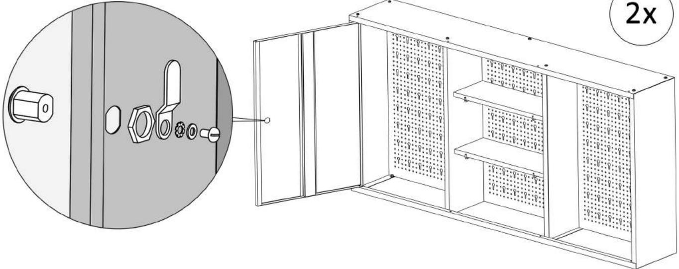
Stecken Sie den Schließzylinder des Schlosses (8) durch die in der Tür vorgesehene Öffnung und fixieren Sie ihn wie in der Abbildung. Prüfen Sie vorher, ob die Schließrichtung korrekt ist. Wiederholen Sie den Vorgang für die andere Tür.
