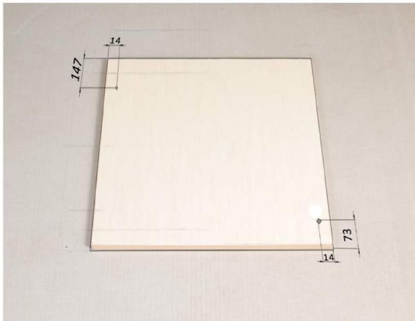
Legen Sie die Arbeitsplatte mit der Arbeitsseite auf eine vor Kratzern schützende Unterlage. Markieren Sie auf der Arbeitsplatte die gekennzeichneten Positionen.
