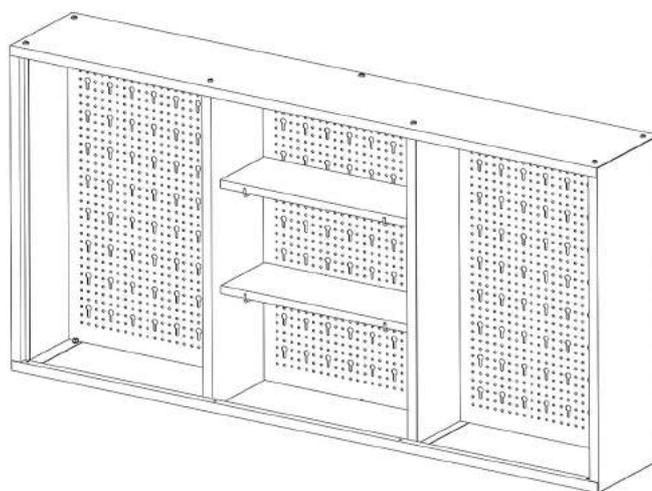
Stecken Sie nun die vier Halterungen für die Einlegeböden (5) in die Rückwände. Legen Sie die Einlegeböden (5) dann auf die Halterungen.
