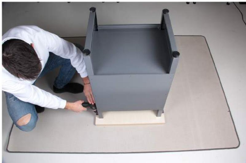
**Tip:** Das Anschrauben der Arbeitsplatte geht einfacher, wenn Sie die Löcher mit einem 4mm Bohrer vorbohren.
