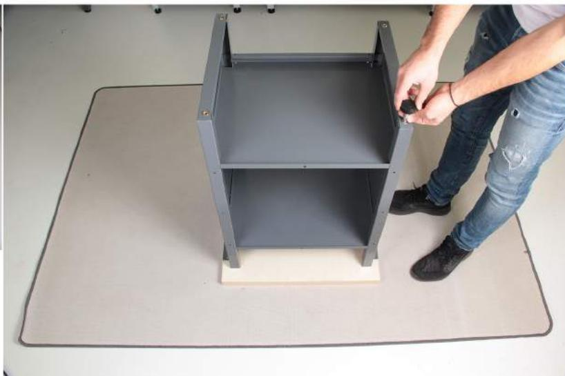
**Hinweis:** Kippen Sie die Werkbank mit einer 2. Person wie abgebildet auf die Arbeitsplatte. Achten Sie darauf, dass nach dem Kippen die obere Mittelwand auf der Arbeitsplatte aufsitzt.
