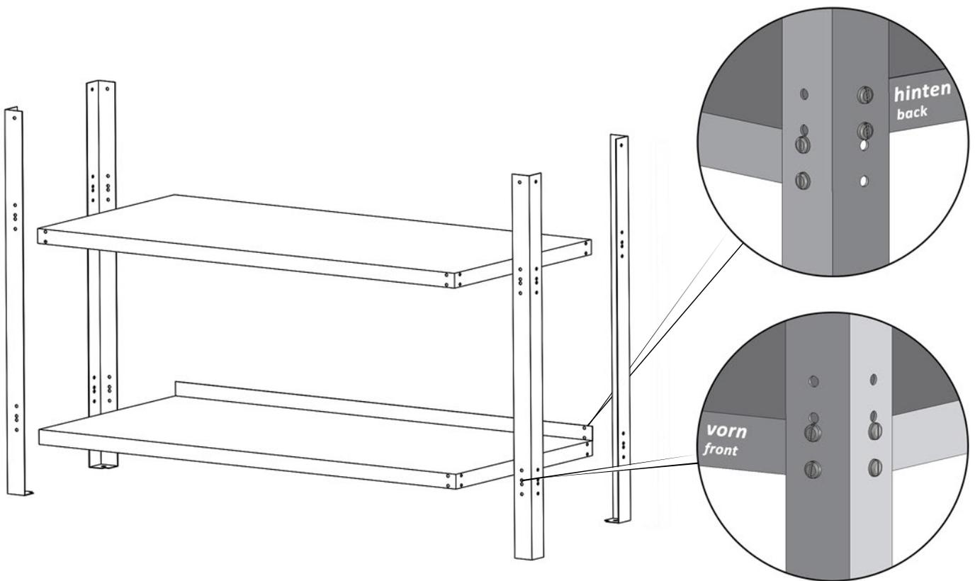
Schraube mit Hilfe von sechzehn Schraubensets (23) alle vier Tischbeine (N1) zuerst an den unteren Fachboden (N4). Nutze an der Vorderseite die beiden untersten Löcher, an der Rückseite die beiden obersten. Die Schraubenköpfe müssen außen platziert werden, die Muttern und Unterlegscheiben innen. Bringe nun auch den oberen Fachboden (N3) an den Tischbeinen an. Hier kannst du die gewünschte Höhe selbst wählen.
