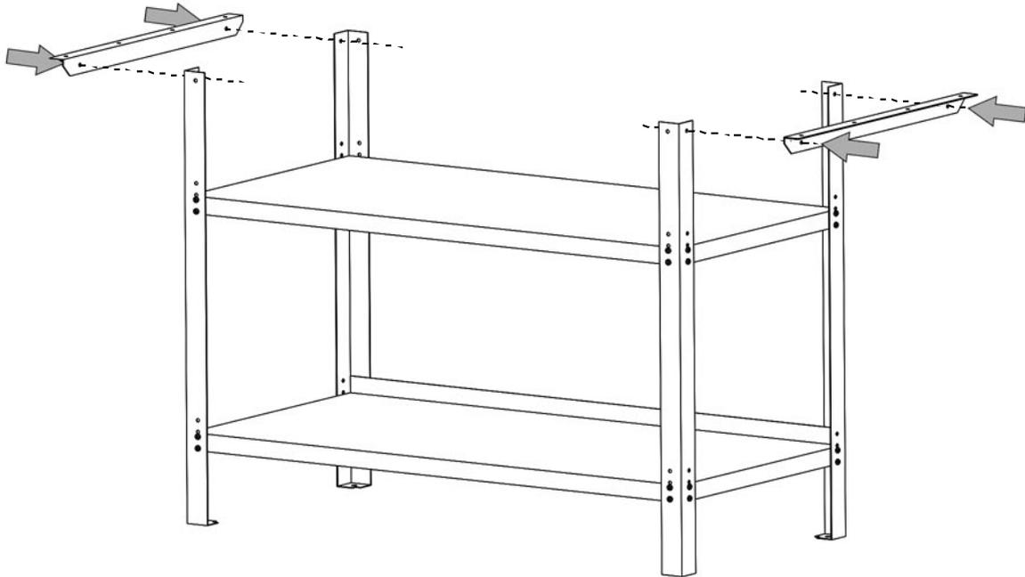
Schraube die beiden Verbindungswinkel (N2) an die obere Seite der Tischbeine.
