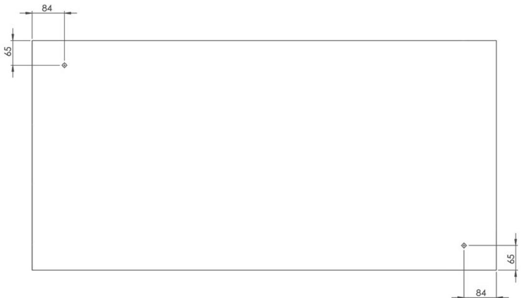
Markiere die benötigten Befestigungspunkte auf der Unterseite der Arbeitsplatte (AP).
