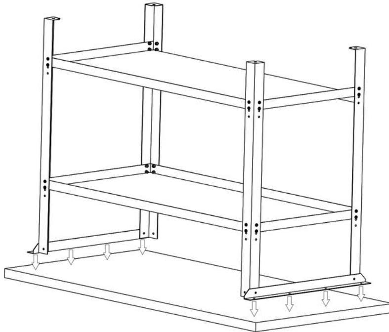
Schraube mit Hilfe von acht Schneidschrauben (25) die Konstruktion auf die Markierungen der Unterseite der Arbeitsplatte (AP).
