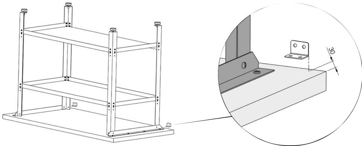
Schraube die beiden Anbauwinkel (AW) mit Hilfe von jeweils zwei Schneidschrauben (25) mit einem Abstand von 30 mm zu den Ecken auf der Rückseite der Arbeitsplatte. Stelle nun die Werkbank wieder auf.
