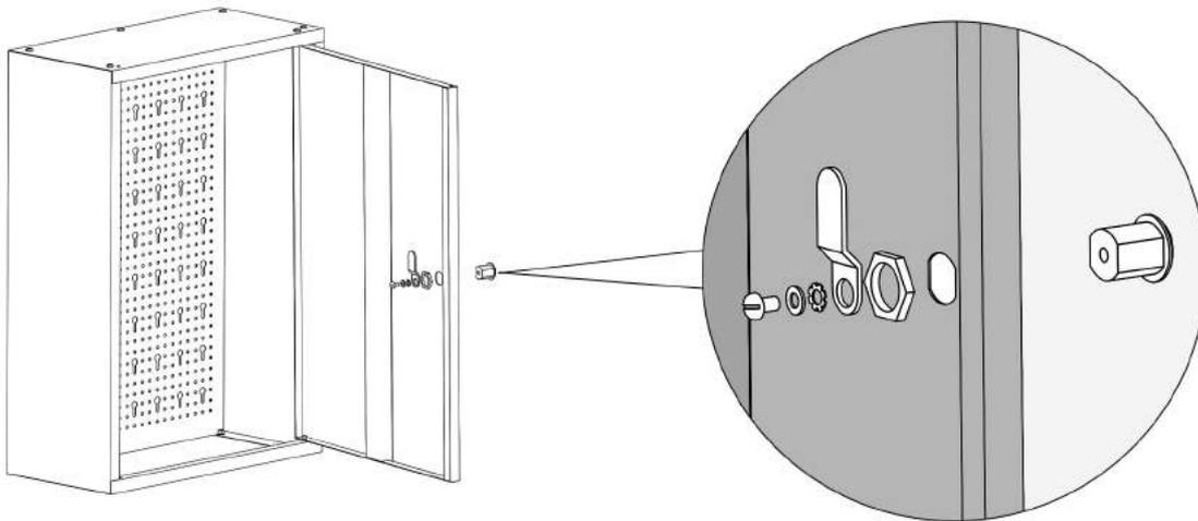
Stecken Sie den Schließzylinder durch die in der Tür vorgesehene Öffnung und fixieren Sie ihn wie in der Abbildung. Prüfen Sie vorher, ob die Schließrichtung korrekt ist.
