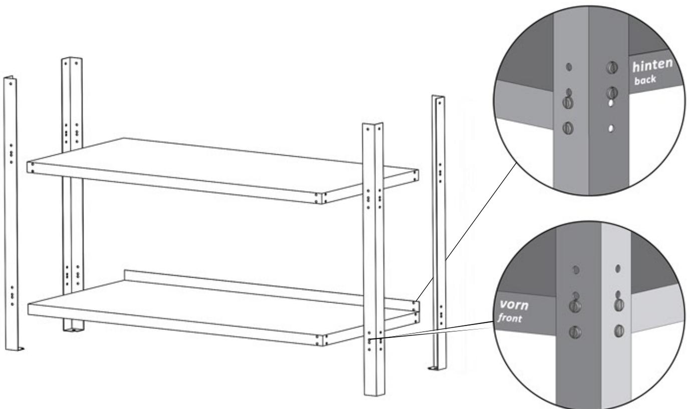
Schrauben Sie mit Hilfe von sechzehn Schraubensets (8) alle vier Tischbeine (N1) zuerst an den unteren Fachboden (N4). Nutzen Sie an der Vorderseite die beiden untersten Löcher, an der Rückseite die beiden obersten. Die Schraubenköpfe platzieren Sie außen, die Muttern und Unterlegscheiben innen. Bringen Sie nun auch den oberen Fachboden (N3) an den Tischbeinen an. Hier können Sie die gewünschte Höhe selbst wählen.
