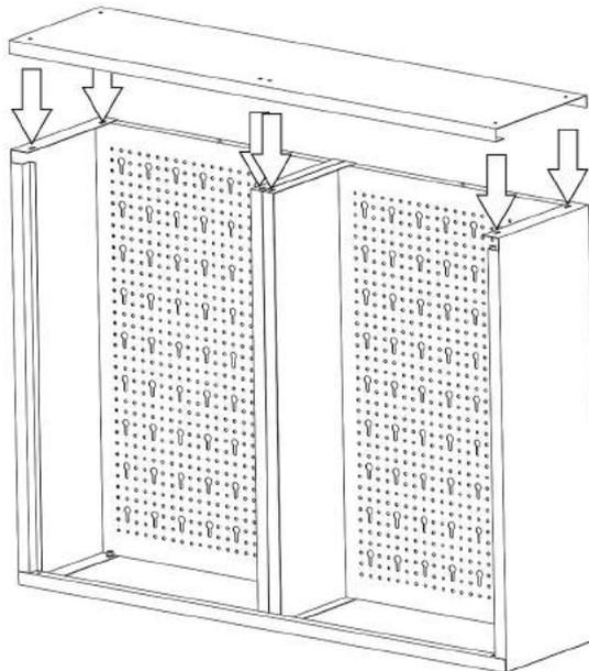
Schrauben Sie jetzt den Deckel (3) auf die Konstruktion. Verschrauben Sie die Mittelwände (4) nun auch mittig mit dem Deckel.
