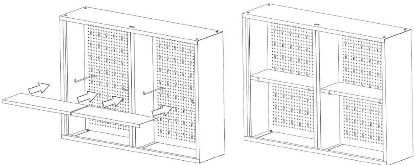
Stecken Sie nun die vier Halterungen für die Einlegeböden (5) in die Rückwände. Legen Sie die Einlegeböden (5) dann auf die Halterungen.
