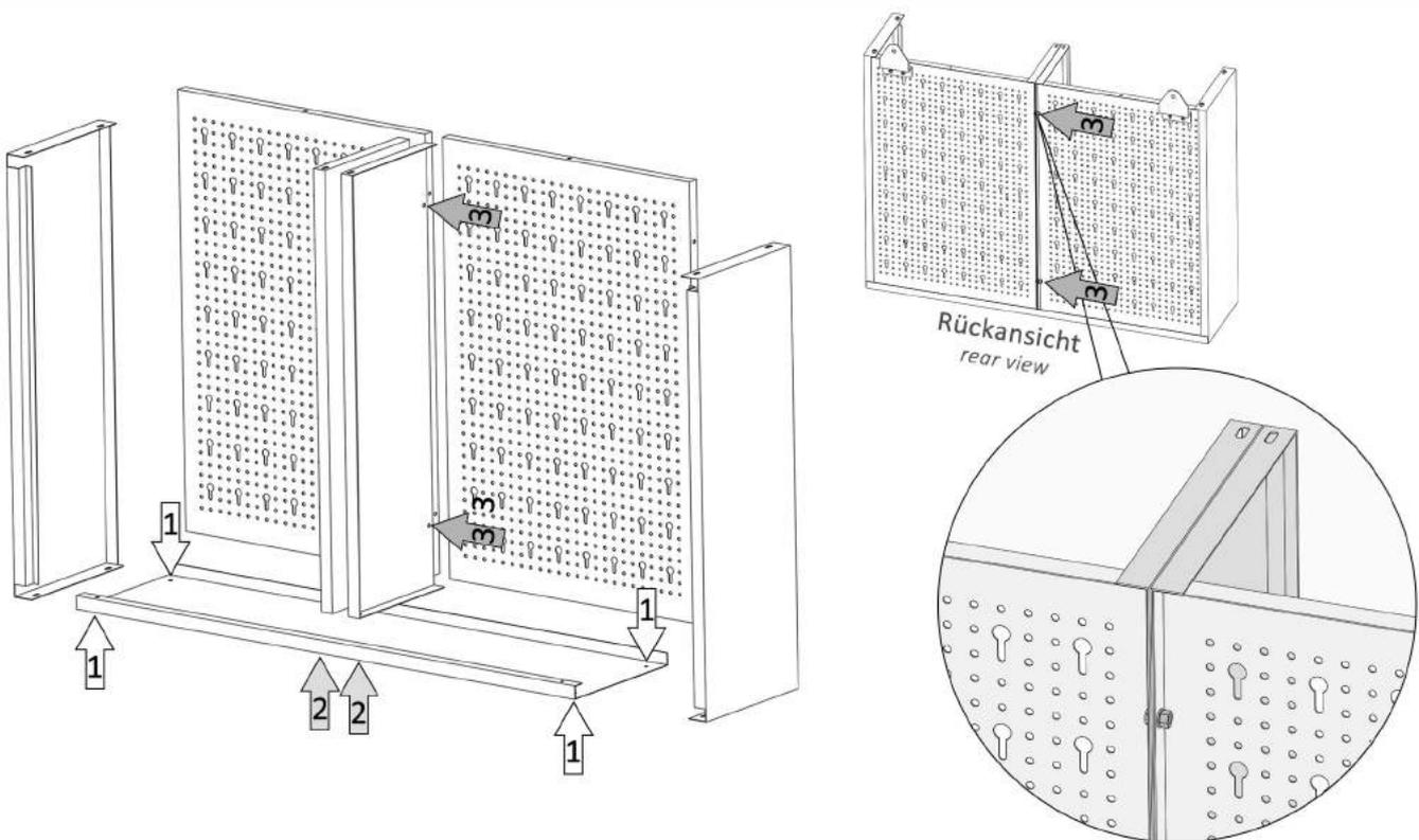
Schrauben Sie die beiden Seitenwände (2) links und rechts an den Boden (3), wobei außen die Schrauben und innen die Muttern und Unterlegscheiben sitzen. Setzen Sie jetzt die beiden Mittelwände (4) wie in der Abbildung gezeigt ein und schrauben Sie diese ebenfalls an das Bodenteil. Platzieren Sie die Rückwände (1) wie abgebildet im Aufbau. Achten Sie darauf, dass die Rückwände richtig herum und mit der Aussparung nach hinten gerichtet sind! Verschrauben Sie die Rückwände nun mit den Mittelwänden.
