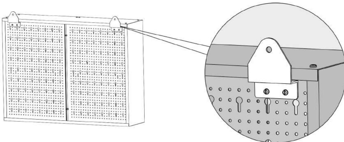
Befestigen Sie die beiden Aufhängungen (7) wie abgebildet mit je zwei Schraubensets links und rechts an der Rückwand.
