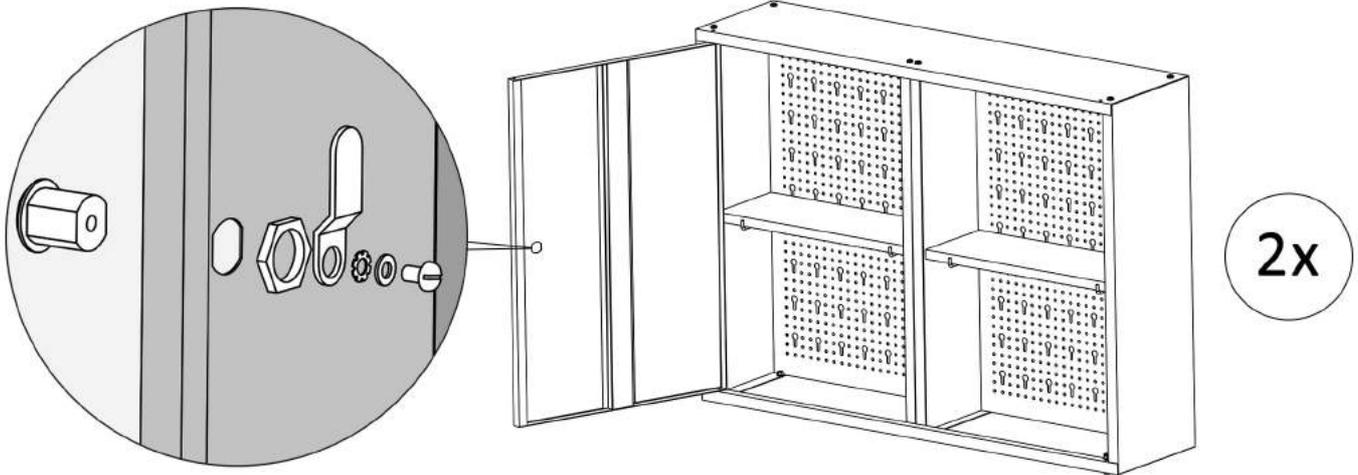
Stecken Sie den Schließzylinder des Schlosses (8) durch die in der Tür vorgesehene Öffnung und fixieren Sie ihn wie in der Abbildung. Prüfen Sie vorher, ob die Schließrichtung korrekt ist. Wiederholen Sie den Vorgang für die andere Tür.
