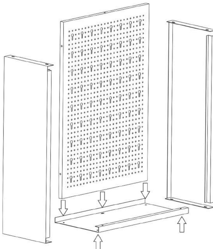
Legen Sie das Unterteil (1) auf den Boden und schrauben Sie die beiden Seitenteile (2) rechts und links an das Unterteil, wobei außen die Schraube, innen die Muttern und Unterlegscheiben sitzen. Klemmen Sie nun die Rückwand (3) in die Konstruktion. Achten Sie darauf, dass die Rückwand richtig herum angebracht ist und mit der Aussparung nach hinten gerichtet ist. Verschrauben Sie diese nun mittig mit dem Bodenteil.
