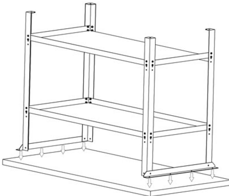
Schrauben Sie mit Hilfe von acht Schneidschrauben (9) die Konstruktion auf die Markierungen der Unterseite der Arbeitsplatte (AP).
