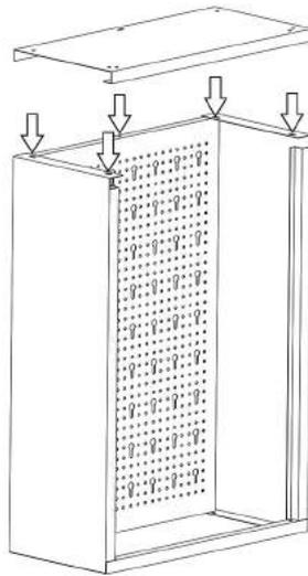
Schrauben Sie jetzt das Oberteil (1) auf die Konstruktion. Verschrauben Sie die Rückwand (3) nun auch mittig mit dem Deckel (1).
