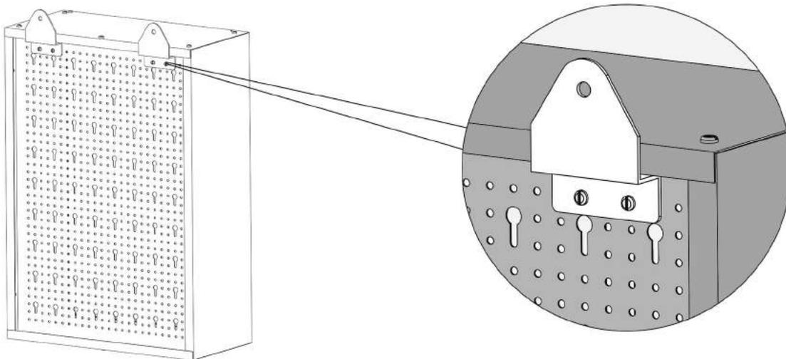
Befestigen Sie die Aufhängungen (5) wie abgebildet mit je zwei Schraubensets (8) links und rechts an der Rückwand. Schrauben Sie den Werkstattschrank an die Wand. Vergewissern Sie sich vor der Wandmontage, ob die gewählten Schrauben und Dübel für Ihre Wand geeignet sind.
