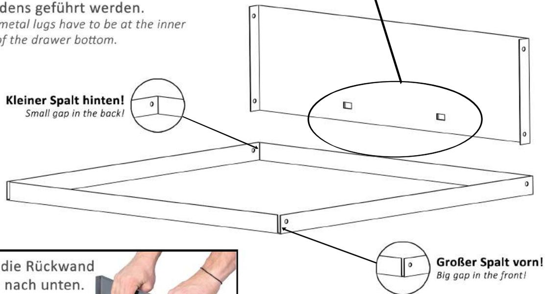
**Tip:** Drücken Sie die Rückwand mit beiden Händen nach unten.
