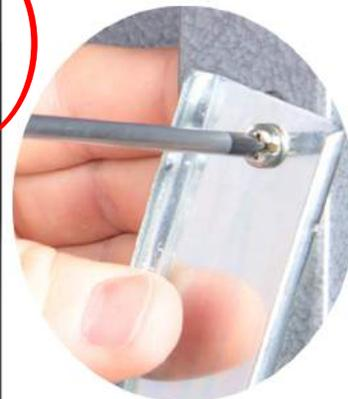
Schrauben Sie die Schubladenschielen (S4) wie dargestellt mit je 2 Schraubensets M5x8 (23) an die Seitenwand 1 und die Seitenwand 2 an. Wiederholen Sie Schritt 1 für jede Schublade. Die Anzahl der Schubladen Ihrer Werkbank können Sie der Stückliste auf Seite 5 entnehmen.
