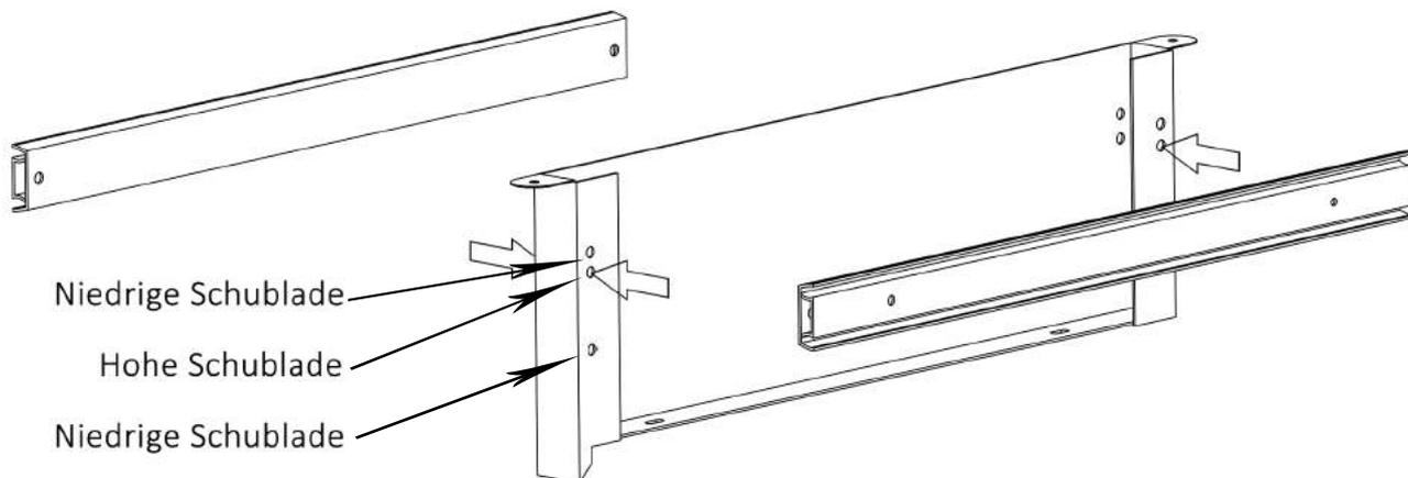
Schrauben Sie jetzt je eine Schubladenföhrung (S4) an beide Seiten der oberen Mittelwand (5). Für Tips und Hinweise zum Befestigen der Schubladenschienen, schauen Sie bitte bei Schritt 2.
