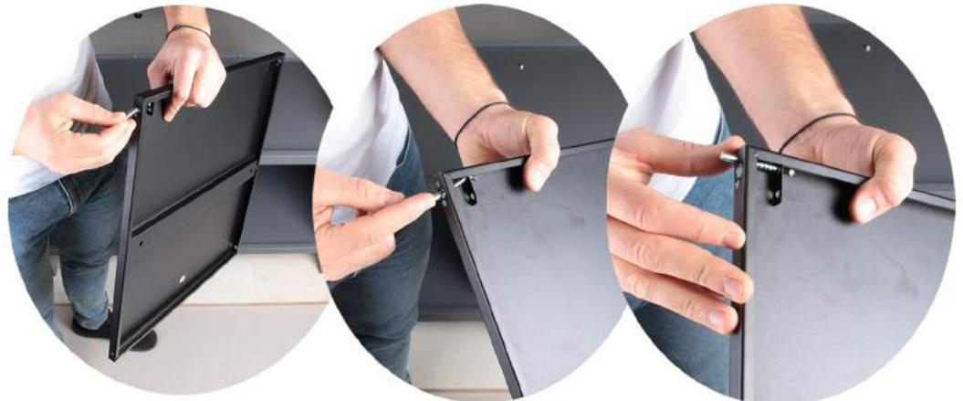
Führen Sie den Federsplint mit dem gewinkelten Ende zuerst in das große der drei Löcher. Danach schieben Sie das gewinkelte Ende wie dargestellt in das äußere Loch und zwar soweit, bis der ganze Stift durch das erste große geschoben ist. Danach führen sie das gerade Ende rückwärts durch das obere äußere Loch. Wiederholen Sie diesen Schritt auf der gegenüberliegenden Seite der Tür.
