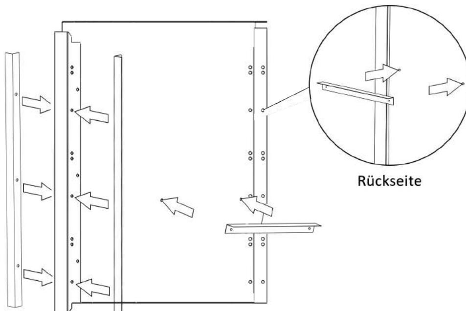
Schrauben Sie die Türanschläge (D4) an beide Seiten der unteren Mittelwand (6).
