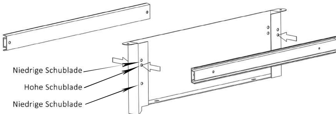
Schrauben Sie jetzt je eine Schubladenführung (S4) an beide Seiten der oberen Mittelwand (5).
