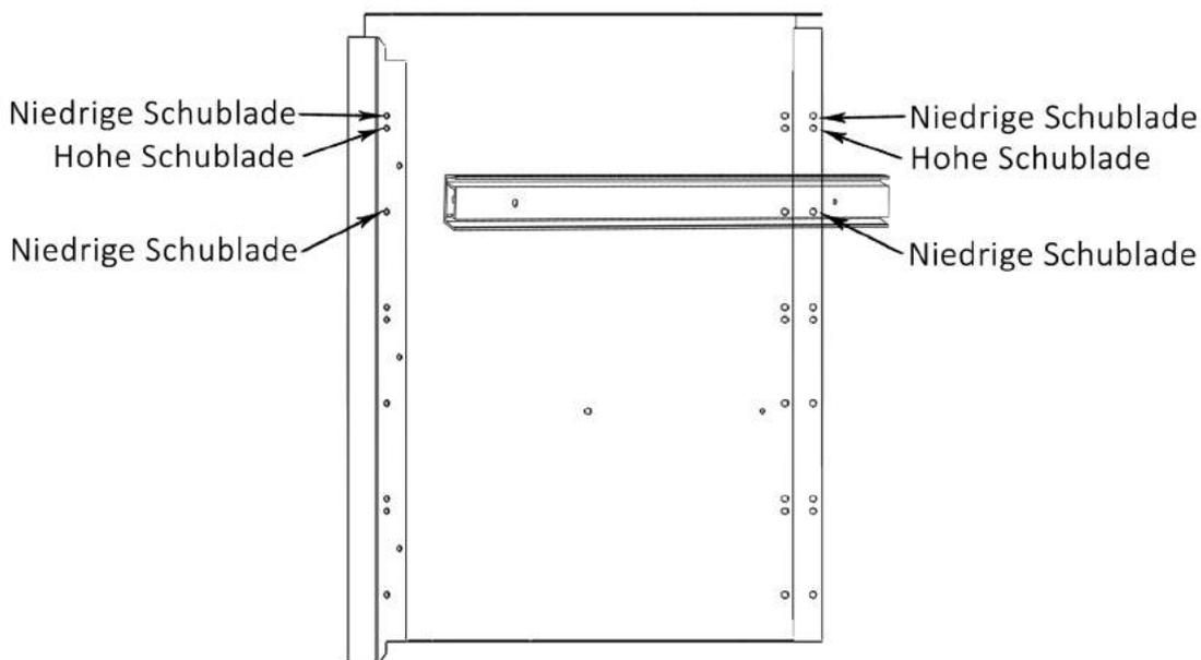
Schrauben Sie die Schubladenschienen wie im Bild dargestellt an beide Seiten der unteren Mittelwand. Nutzen Sie dafür die Schraubensets M5x8 (23). Wiederholen Sie diesen Schritt für jede Schublade. Die Anzahl der Schubladen Ihrer Werkbank können Sie der Stückliste auf Seite 5 entnehmen. Für Tips und Hinweise zum Befestigen der Schubladenschienen, schauen Sie bitte bei Schritt 2. **ACHTUNG:** Die Schraubenköpfe müssen in Richtung der Schubladenschienen zeigen.
