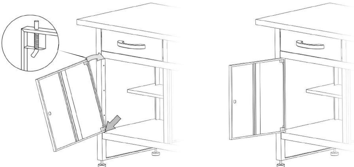
Bringen Sie die Tür in Position zu den Türsplint-Löchern im Werkbank-Korpus und stecken oben und unten je einen Federsplint (26) in die vorgesehenen Türlöcher mit der Feder in der Türsplint-Vorrichtung (siehe Detail-Abbildung). Wiederholen Sie diesen Schritt für jede Tür Ihrer Werkbank. Herzlichen Glückwunsch, Ihre Werkbank ist nun fertig.
