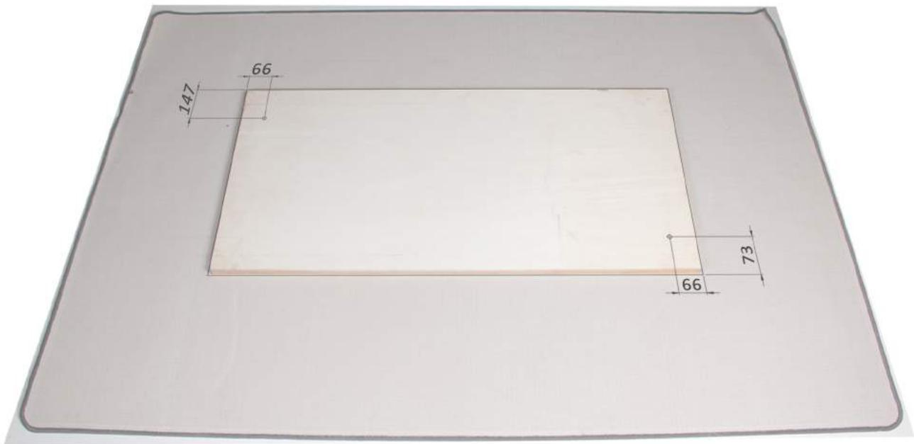
Legen Sie die Arbeitsplatte (AP) mit der Arbeitsseite auf eine vor Kratzern schützende Unterlage. Markieren Sie auf der Arbeitsplatte die gekennzeichneten Positionen.
