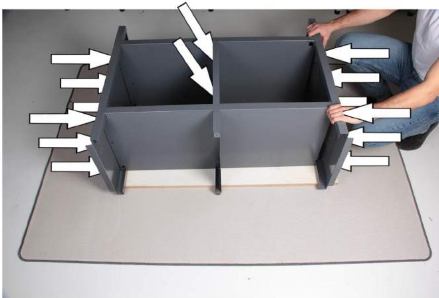
Verschrauben Sie die Fachböden (4) mit den Seitenwänden (1,2) und der unteren Mittelwand (6) an den gekennzeichneten Stellen.
