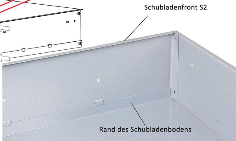
Verschrauben Sie die Schubladenfront (S2) mit dem Schubladenboden (S3) und den Schubladenseitenwänden (S5) an den gekennzeichneten Stellen.
