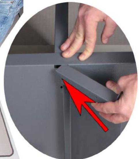
Führen Sie die Nase der oberen Mittelwand (5) von oben in die rechteckige Aussparung des Fachbodens (4). Schrauben Sie nun die untere Mittelwand, den Fachboden und die obere Mittelwand mit dem Schraubenset M5x8 (23) an den zwei gekennzeichneten Punkten zusammen. Der Schraubenkopf muss in richtung der oberen Mittelwand (5) zeigen.
