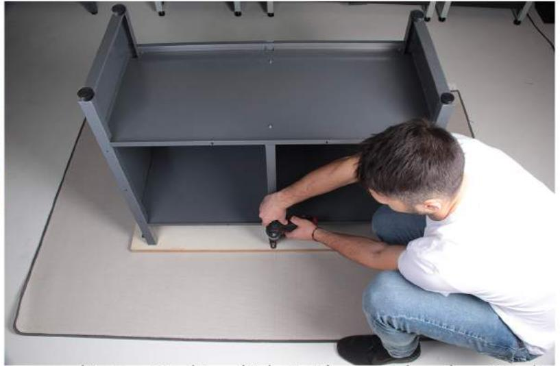
**Tip:** Das Anschrauben der Arbeitsplatte geht einfacher, wenn Sie die Löcher mit einem 4mm Bohrer vorbohren.
